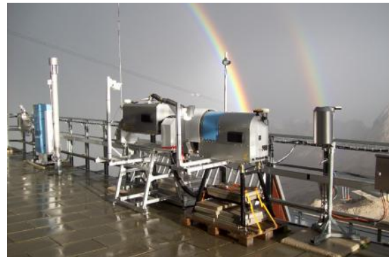
Abb.1: Mikrowellenradiometer HATPRO (rechts, 22-60 GHz) und DPR (links, 90+150 GHz) auf der Messterrasse der UFS. Die Kombination beider Geräte liefert seit über einem Jahrzehnt kontinuierliche Messungen des Flüssigwasser- und Wasserdampfgehalts der Atmosphäre über der UFS, sowie Informationen über Temperatur-, Luftfeuchteverteilung und Schneefalleigenschaften (Quicklooks zu allen Daten und Produkten frei zugänglich auf: http://gop.meteo.uni-koeln.de/~hatpro/dataBrowser ).
